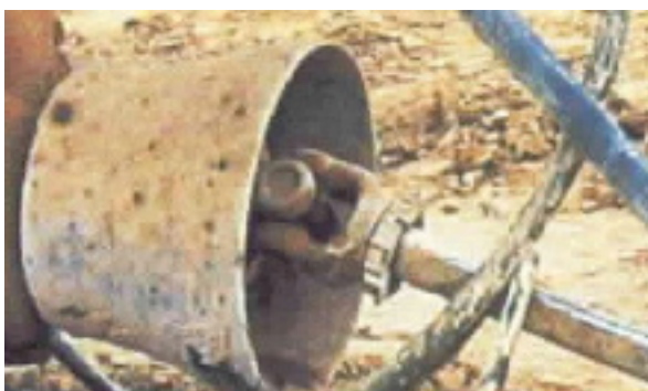
4 pav. Besisukančių elementų apsaugai: a) negalima naudoti; b) galima naudoti (Deikus, 2008)
